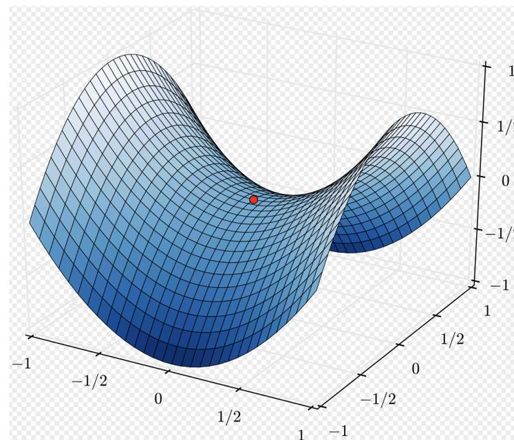
图中给出了  $f(x, y) = x^2 - y^2$  的图像, 形象地解释了这一定理。
